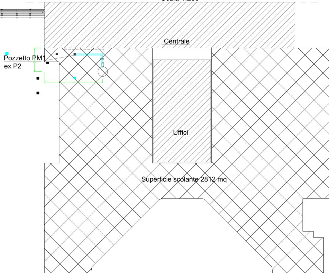
Dimensionamento vasca prima pioggia =  $(2800 \text{ mq} / 10000 \text{ mq}) * 50 \text{ mc} = 14.07 \text{ mc} \approx 15.00 \text{ mc}$
